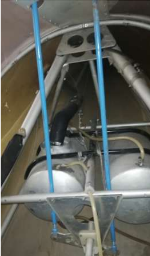
Obrázek 6 Zástavba palivových nádrží
