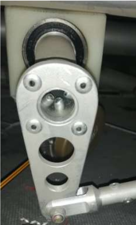
Obrázek 13 Přinýtování páky k torzní trubce
