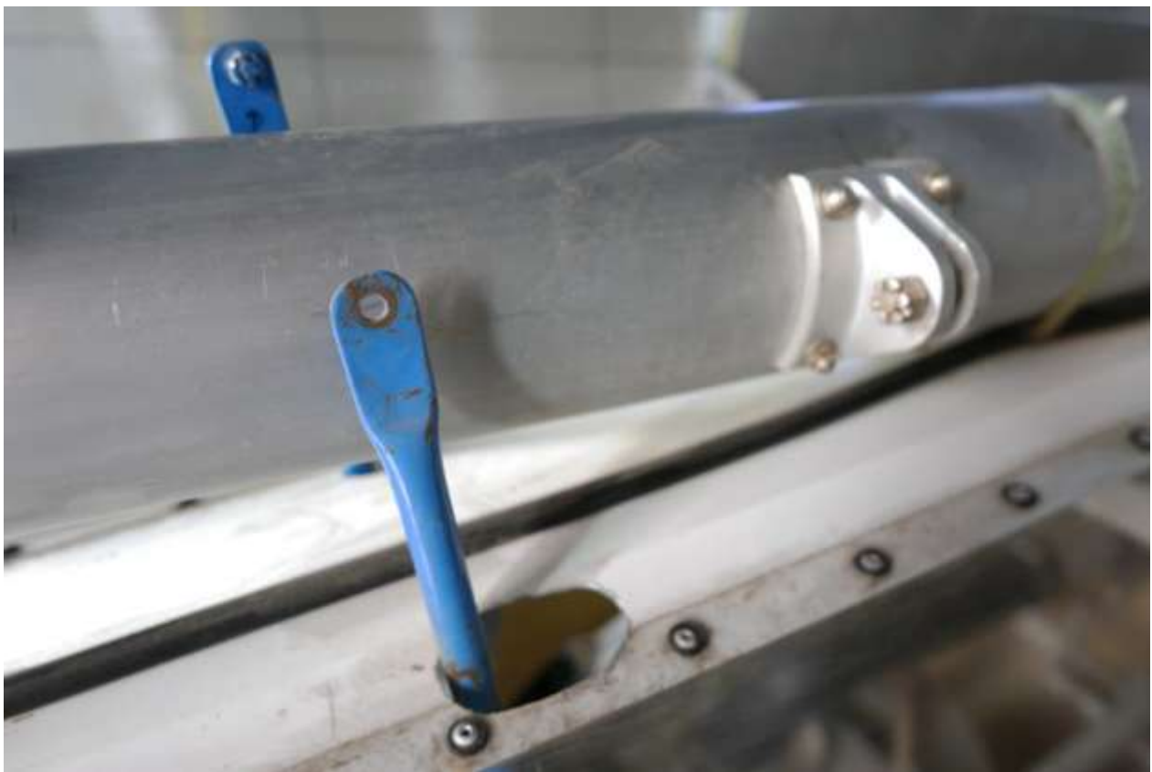
Obrázek 7 Výstup táhel z trupu (Zdroj [1])
