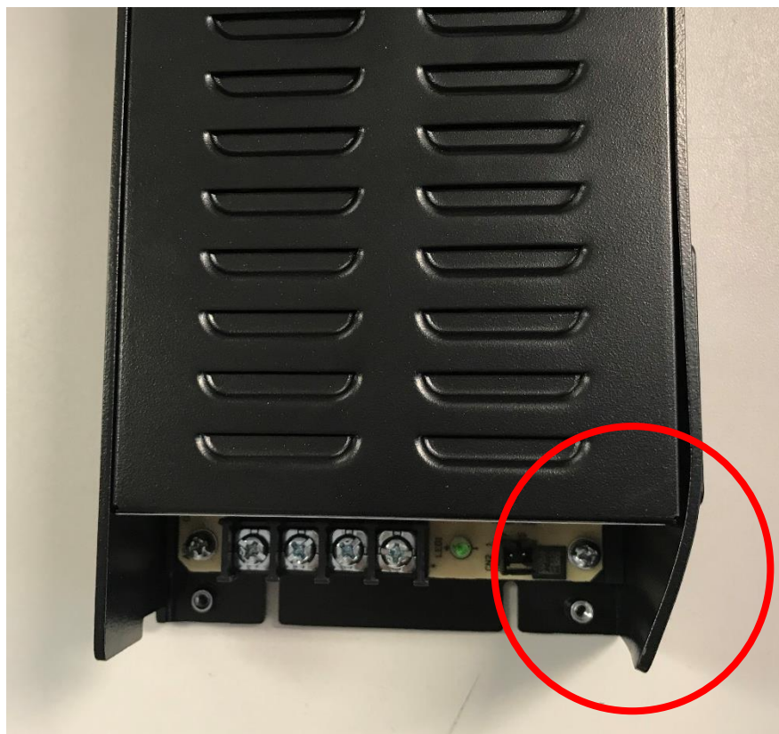
Obrázek 8 - Mechanické poškození DELTA PSU [vlastní foto]
