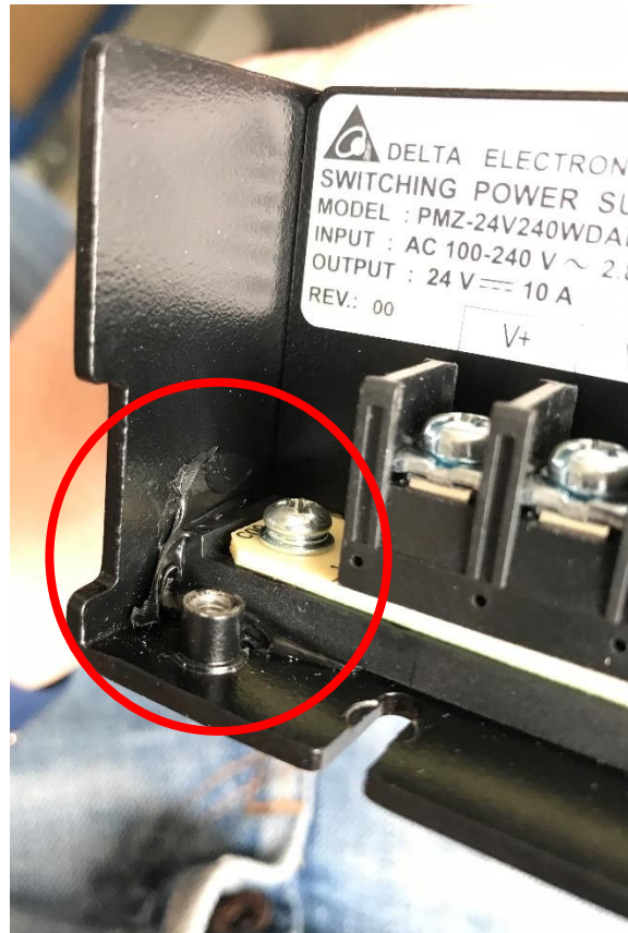
Obrázek 9 - Příklad ostatní vady, vyteklé lepidlo [vlastní foto]
