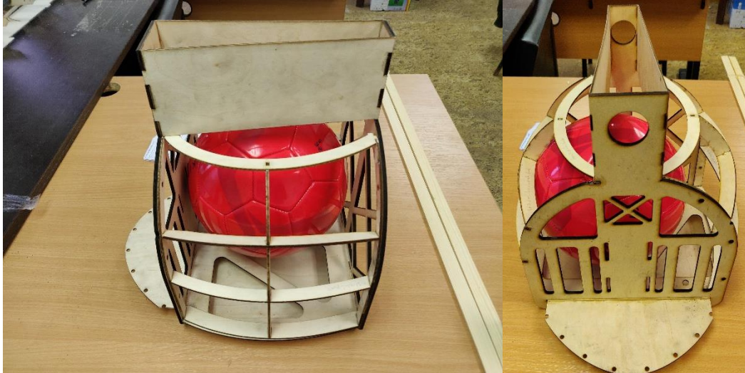
Obr. 39 Sestavení kostry gondoly z překližky před vlepem jádra podlážky a uložení podvozku
