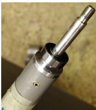
Obr. 41 Hřídelka nasazená a axiálně zajištěná na trubce s jedním nasazeným ložiskem
