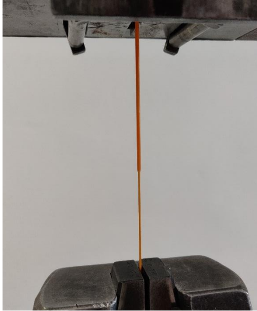
Obr. 68 Vytvoření krčku u vzorku PLA
