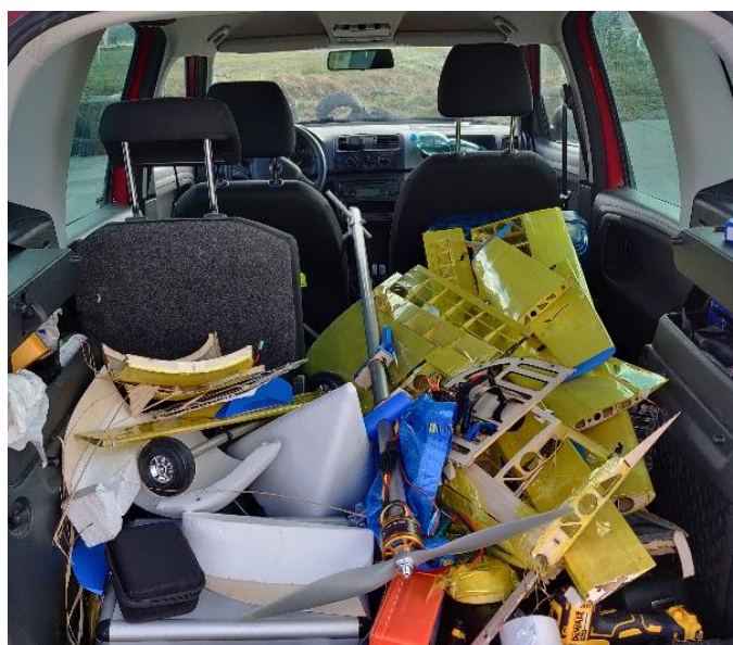
Obr. 49 Stav nalezených součástí letounu
