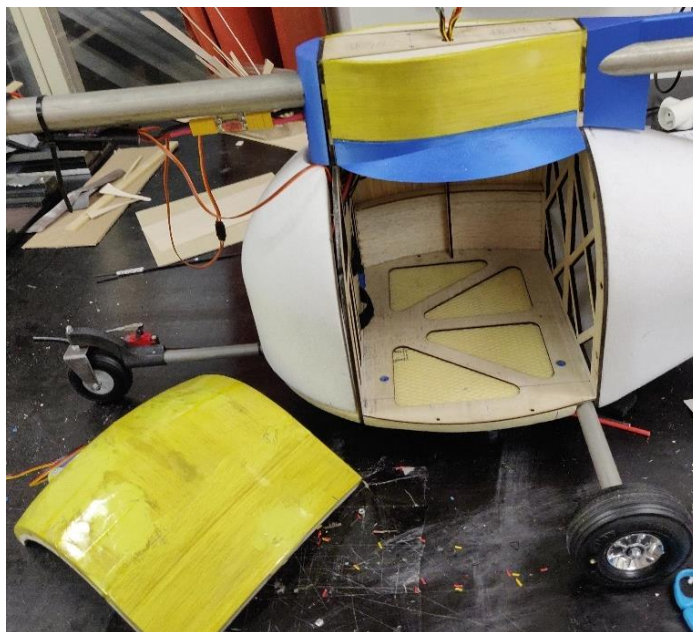
Obr. 43 Ze vnitř dobře viditelný balsový potah a fólií potažené dveře
