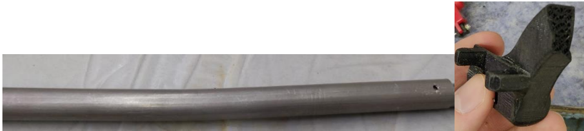
Obr. 50 Součásti poškozené při záletu – trubka hl. podvozku (levo), rameno př. podvozku (vpravo)
