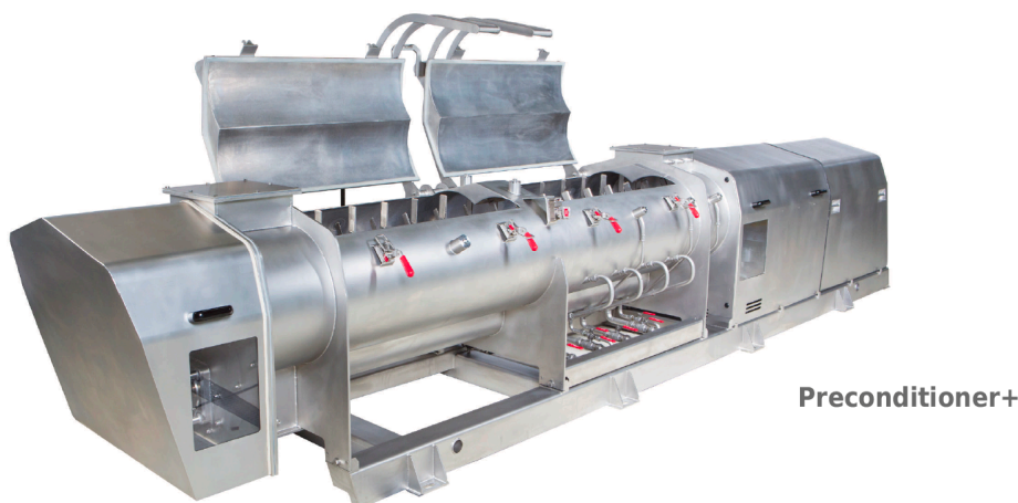
Obr. 11: stroj na předvaření, tzv. preconditioner [30]
