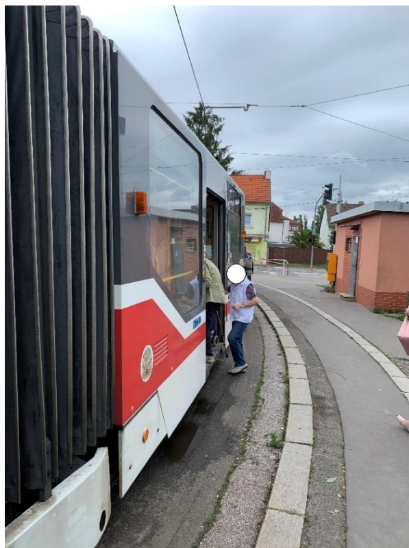
Obrázek 11 Problematický nástup cestujících s omezenou schopností pohybu i přes vypravení nízkopodlažní tramvaje typu KT8D5.RN2P
