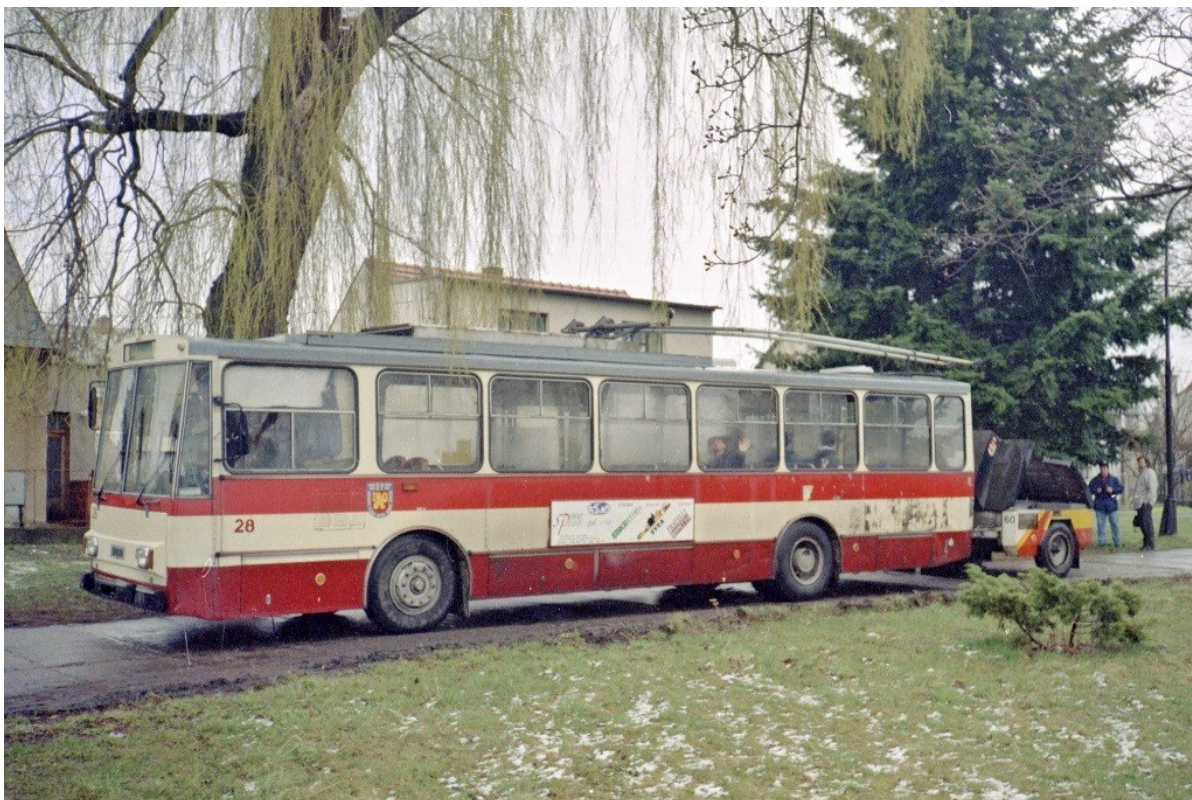
Obrázek 4: Hradecký unikát v podobě vozu Škoda 14 Tr s pomocným naftovým generátorem na konečné Kluky v roce 1996, zdroj [7]
