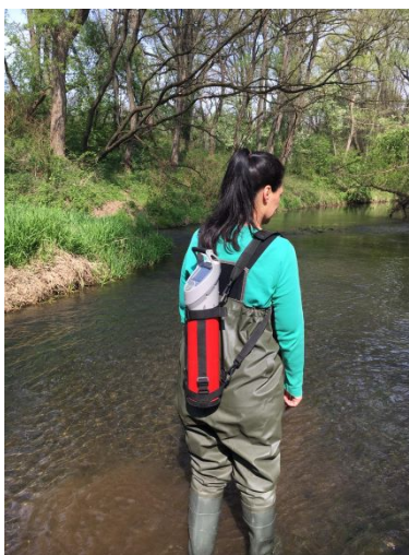
Obrázek 3.1.3: Fotografie zachycující měření PPDE spektrometrem GT-40 firmy Georadis umístěného v popruhu na záda ulehčující měření ve standardní geometrii a zajišťující její udržení během celé doby měření.
