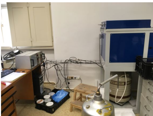
Obrázek 3.2.1: Fotografie spektrometrické trasy s HPGe detektorem chlazeným kapalným dusíkem pomocí Dewarovy nádoby v laboratoři FJFI.
