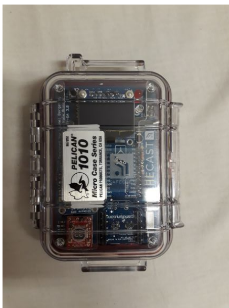
Obrázek 3.1.2: Fotografie přístroje Safecast.
