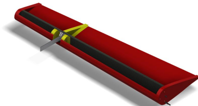
Obr. 9 Konstrukce křídélka se skrytou horní částí potahu
