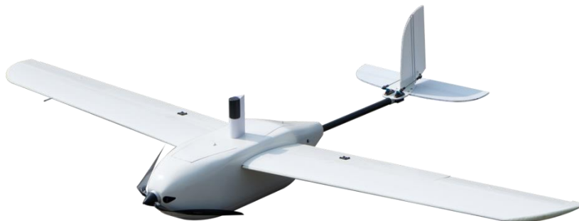
Obr. 2 UA konstrukce s nepohyblivými nosnými plochami (FUTURA™ FIXED WING DRONE) [73]
