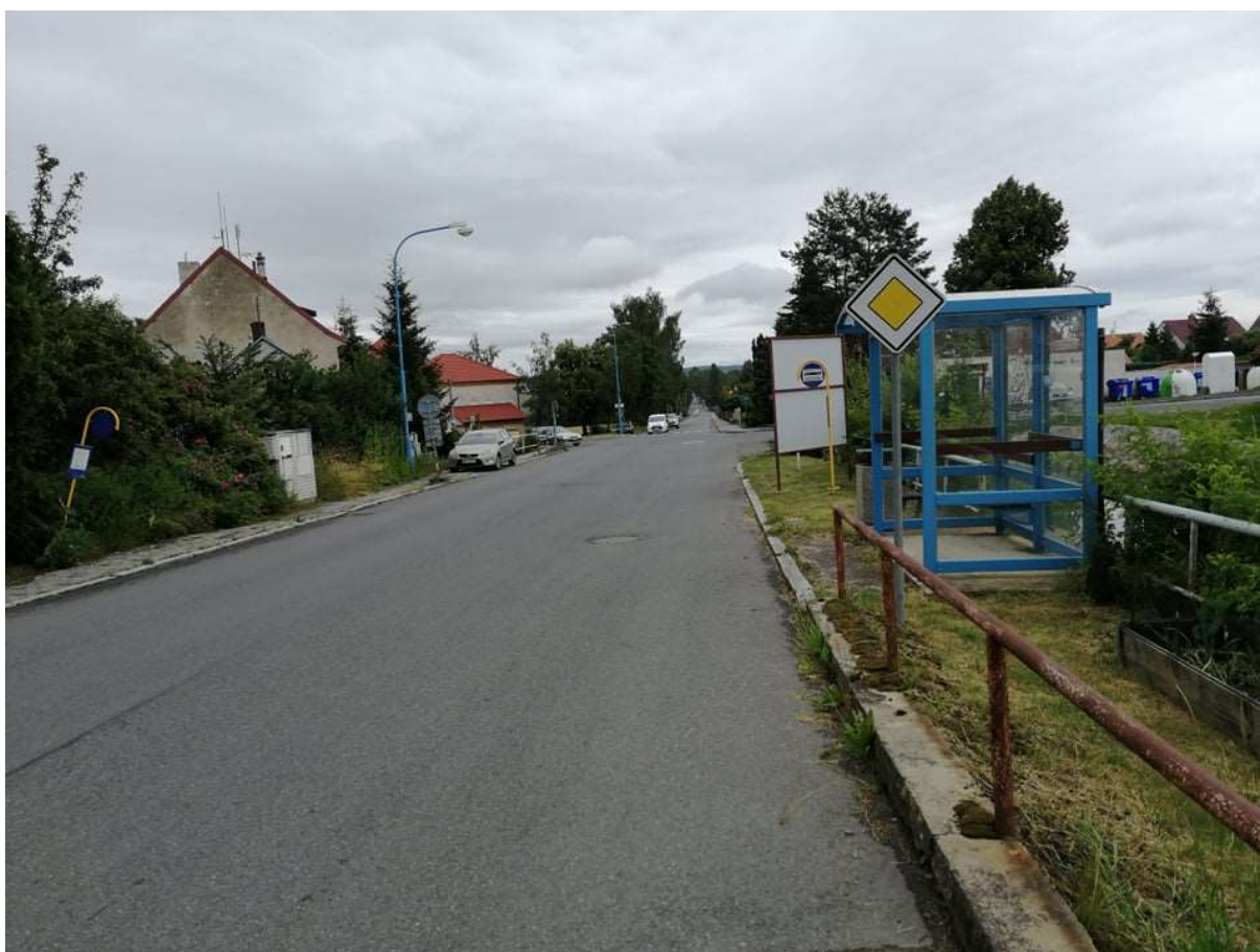
Obr. 22 – pohled na zastávku Jednota ve směru do centra; kvůli nedávné rekonstrukci povrchu vozovky II/191 a její nadbytečné šířce láká tento úplně rovný úsek řidiče k rychlé jízdě, zdroj: vlastní produkce autora
