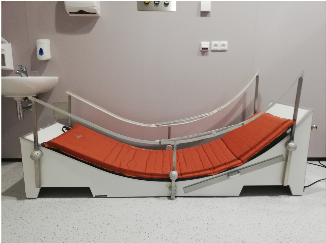
Obr. 3: Fotografie ozařovacího lůžka ve FNHK. Na straně lůžka je viditelný šuplík, do kterého se umísťuje rentgenová kazeta. Lyžiny po stranách lůžka jsou výškově nastavitelné a slouží k umístění PMMA desek co nejtěsněji nad povrch pacienta. Karimatka je zde čistě kvůli zvýšení komfortu pacienta v průběhu ozařování.
