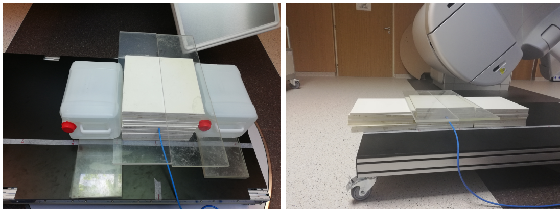
Obr. 11: Nastavení pomůcek při stanovování váhových faktorů. Obdobné nastavení bylo použito také u měření dalších parametrů (profily, hloubkové dávkové křivky). Obrázek vlevo ilustruje měření s fantomem f_{22} . Jelikož nebylo k dispozici tolik RW3 desek, jako rozptylový materiál byly použity kanystry s vodou. Na obrázku vpravo měření s f_{10} . V tomto případě bylo možné RW3 desky využít.
