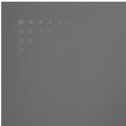
Obr. 12: Rentgenový snímek samotného kontrast-detail fantomu pro akvizční zobrazovací mód, při režimu břišní aorta
