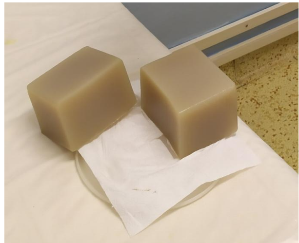
Obr. 13 Vytvořený fantom biologické tkáně a) v plastovém pouzdru, b) rozříznutý fantom
