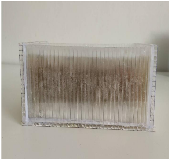
Obr. 13 Vytvořený fantom biologické tkáně a) v plastovém pouzdru, b) rozříznutý fantom
