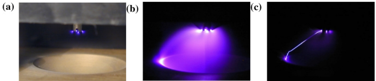
Obr. 6 – (a) korónový výboj (b) doutnáva koróna (c) přechodová jiskra (Ashkiev a kol., 2005).
