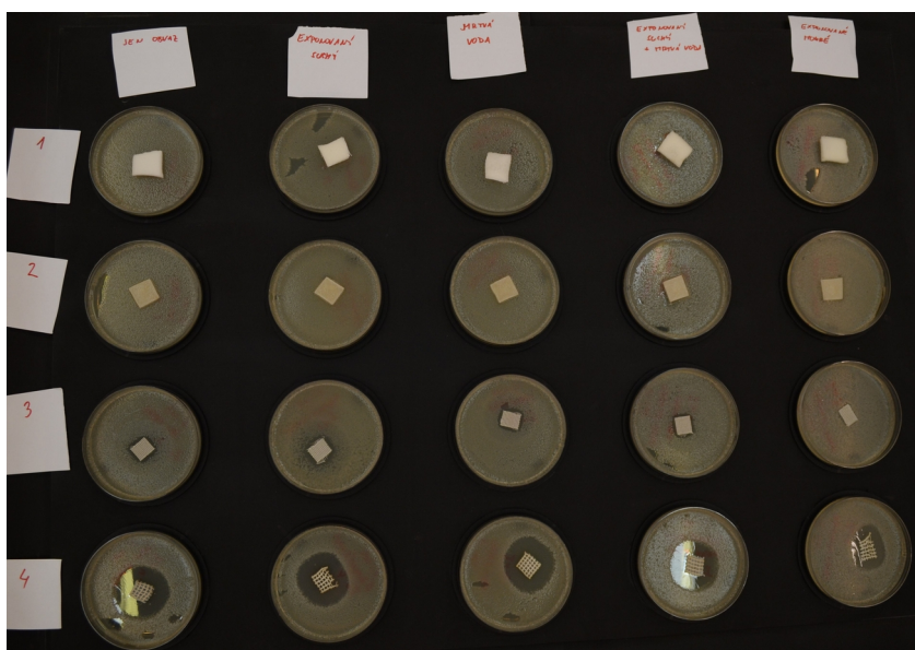
Obr. 12 – E. coli . Čísła určujú typ obvazu 1=Mepilex, 2=Granuflex, 3=Inadine, 4=Ialugen. První sloupec zleva je jen přiložený obvaz (postup 1), druhý je obvaz ošetřený plazmatem suchý (postup 2), třetí je obvaz s kapkou plazmatem ošetřené vody (postup 3), čtvrtý je obvaz ošetřený plazmatem suchý s kapkou plazmatem ošetřené vody (postup 4) a pátý sloupec je obvaz s kapkou vody ošetřený plazmatem (postup 5).
