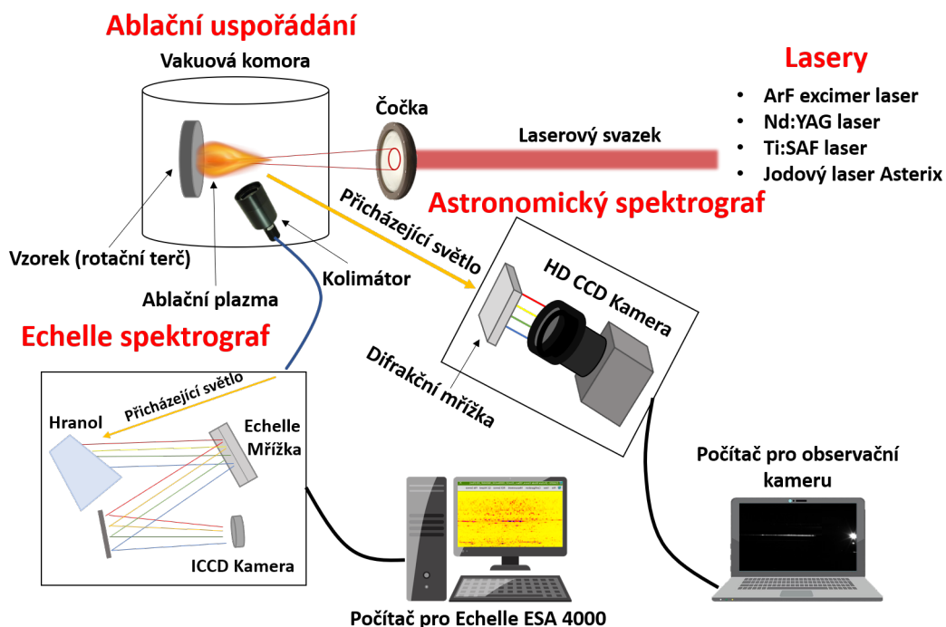
Obr. 5.1: Schéma uspořádána laboratorní LIBS aparatury.
