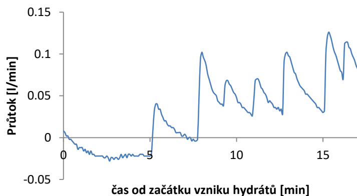
obr.52 Průtok CO_2 . 5. měření při tvorbě hydrátů
