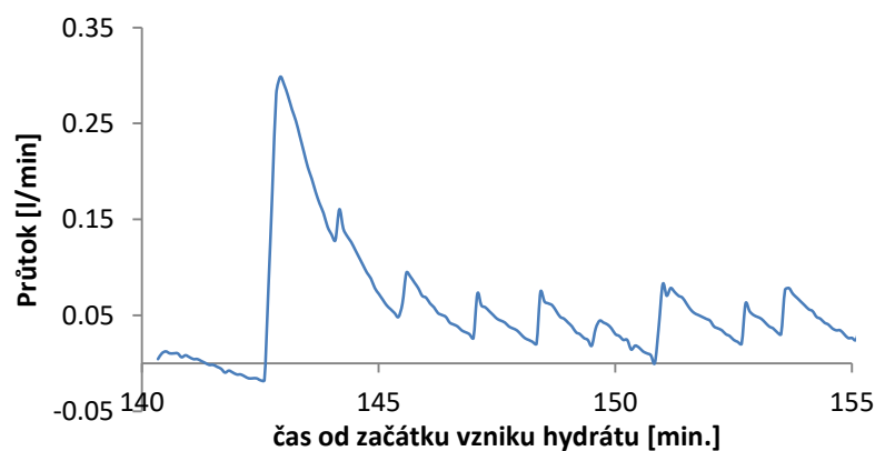
obr.53 Průtok CO_2 . 6. měření při tvorbě hydrátů
