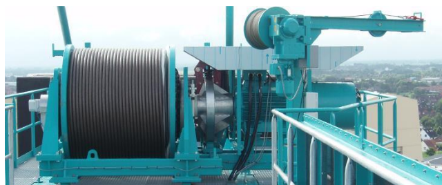
Obrázek 9 Zdvihací jednotka umístěná naproti výložníku [3]
