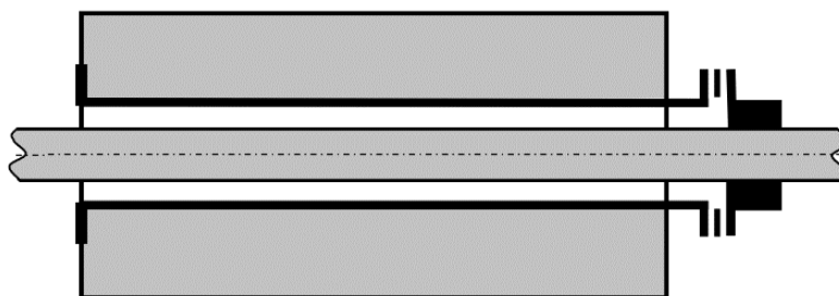
Obrázek 27 - Spojka mezi dutým hřídelem a nápravou na jedné straně trakčního motoru
