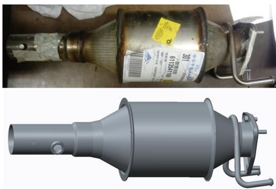
Obr. 8 – Porovnání katalyzátoru a jeho 3D modelu
