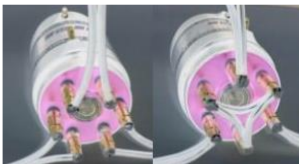
Obrázek 3.3. Zapojení do hvězdy a trojúhelníku [10]
