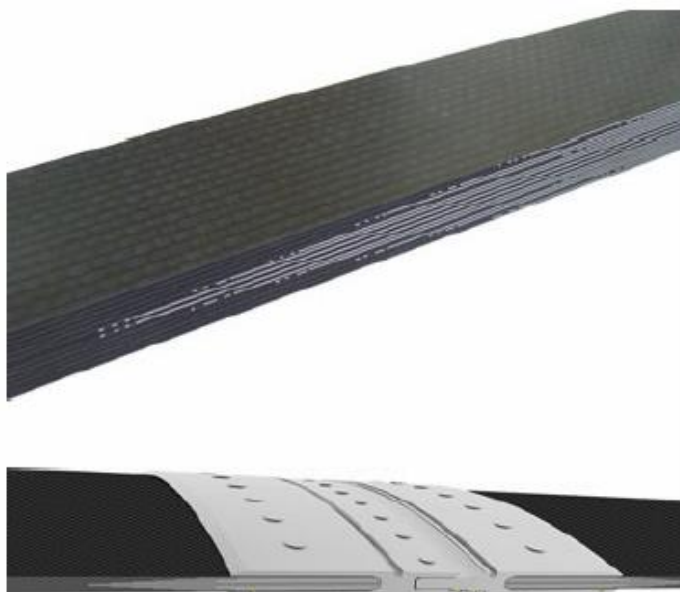
Obrázek 5 Příklad přechodové oblasti a spoje hybridního materiálu CFRP/nerezová ocel [11]
