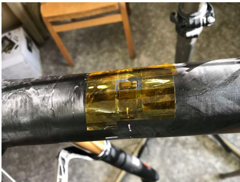
Obr. 8: Instalace tenzometrů na dolní rámovou trubku
