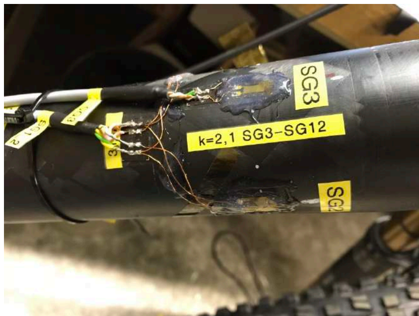
Obr. 11: Čtvrtmostové zapojení tenzometru do Wheatstonova můstku
