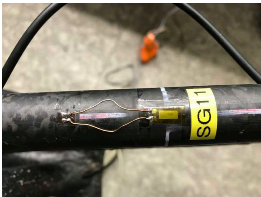
Obr. 10: Čtvrtmostové zapojení tenzometru do Wheatstonova můstku
