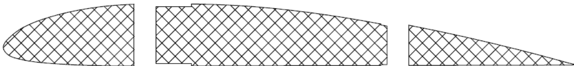
Obr. 20.: Tvar segmentov rebra a požadovaný smer vlákien poťahovej sklenej textílie
