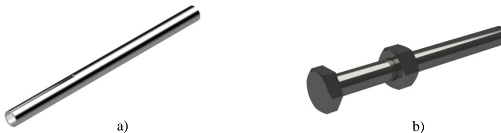
Obr. 28.: Zľava: a) Držiak brúsneho papiera b) Upínací prvok pre koncovku tiahla
