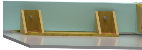
Obr. 49.: Odklopené křídlo zaistené pomocou skrutky
