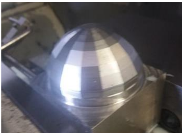
Obrázek 36- Diskokoule po dokončení na 3- osém obráběcím centru
