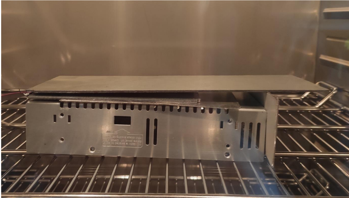
Obr. 11 - Provizorní kovový kryt desky s měděnými senzory teploty
