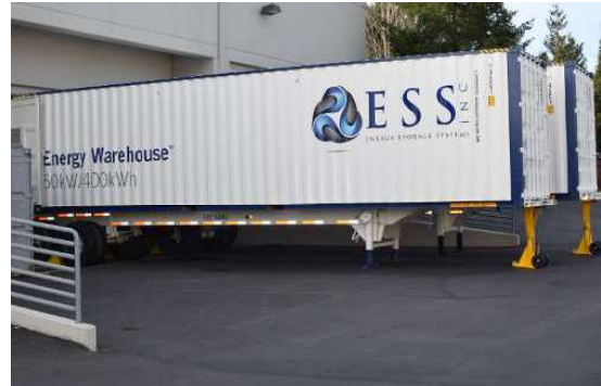
Obrázek 35 Mobilní průtokové baterie [16]
