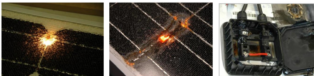
Obrázek 7.2 Ukázky oblouků v FV modulu [5]
