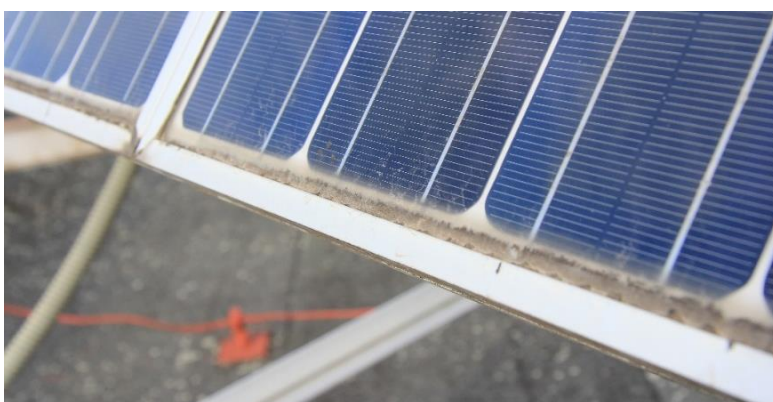
Obrázek 8.5 Znečištění na FVE7 po 17letém provozu
