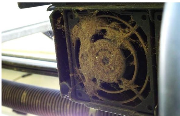
Obrázek 5.8 Znečištěný filtr u střídače (laboratoř ČVUT FEL)
