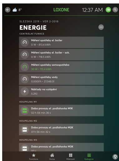
Obrázek 2.14: Výpočet nákladů na provoz elektrické části vytápění
