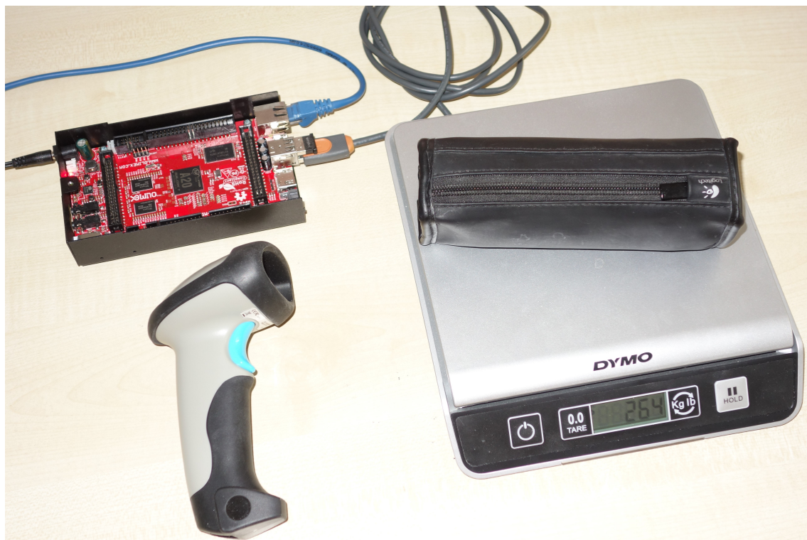
Obrázek 5.2: Embedded setup - váha a bluetooth čtečka, data streamována přes ethernet
