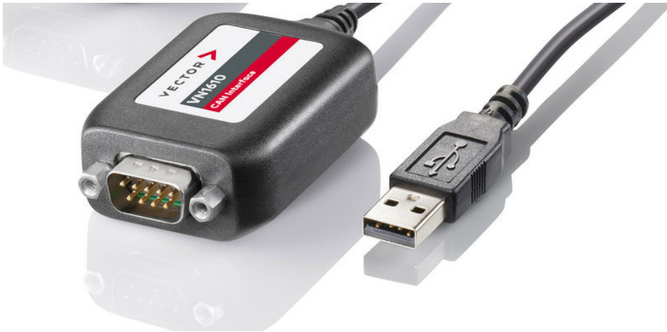
Obrázek 1.3: Převodník vector VN1610. Převzato z [24].
