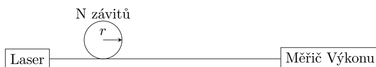
Obrázek 6.2: Schéma pro měření ohybu bez vidového filtru
