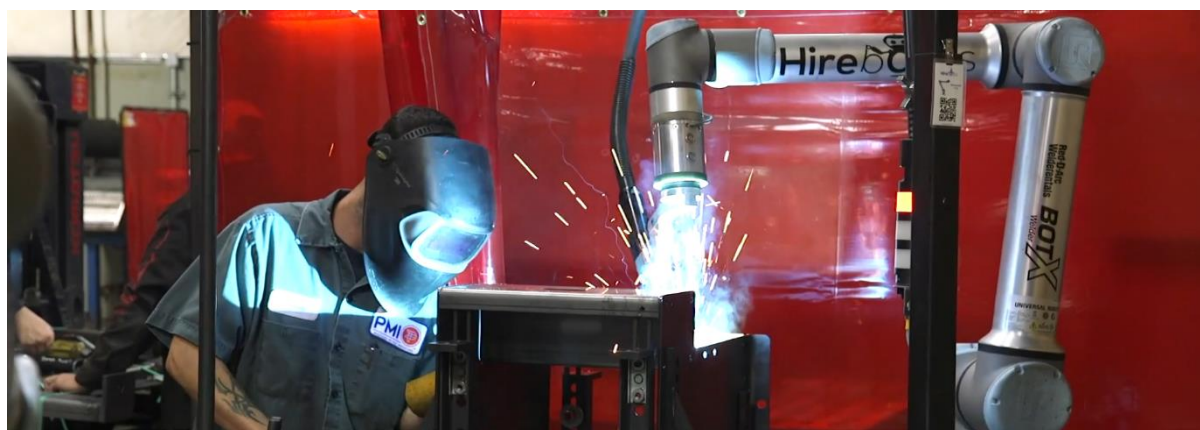
Obrázek 24 - sváření kolaborativním robotem [31]
