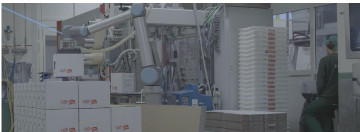
Obrázek 20 - rovnání krabic na paletu [27]
