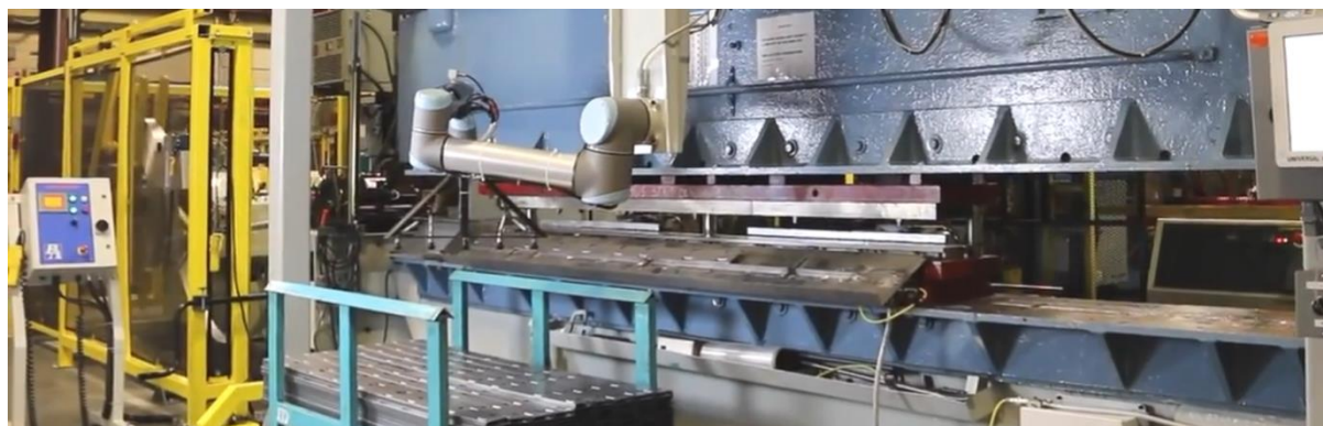
Obrázek 23 - odběr plechů od lisu [30]
