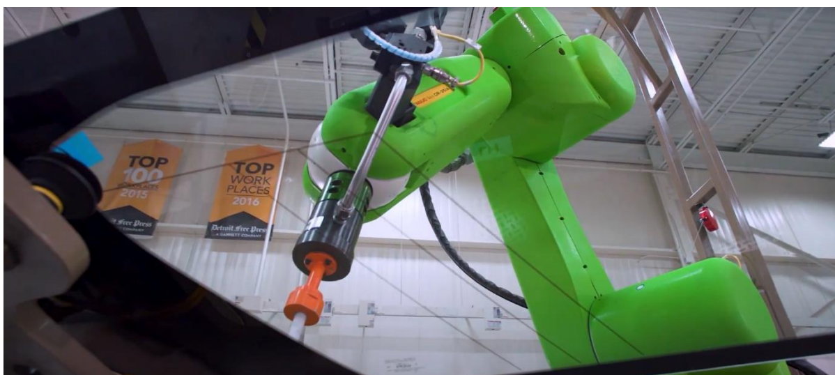
Obrázek 19 - nános polyuretanového lepidla na čelní sklo [26]
