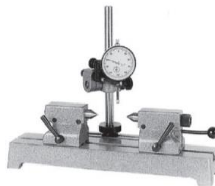
Obrázek 28 - Hrotový přístroj k upnutí součásti [23]
