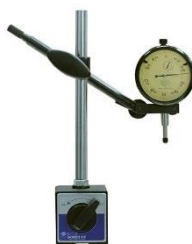
Obrázek 29 - Magnetický stojánek pro uchycení úchylkoměru [19]
