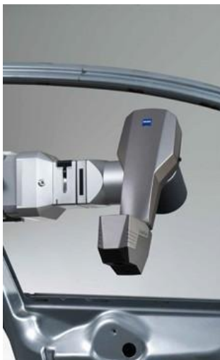
Obr. 30 Měření bezdotykovým laserovým snímacím systémem [25]
