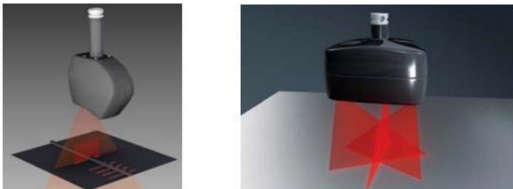
Obr. 40 Porovnání 2D laseru a hlavou se třemi rovinami osvitu (laserový kříž) [40]
