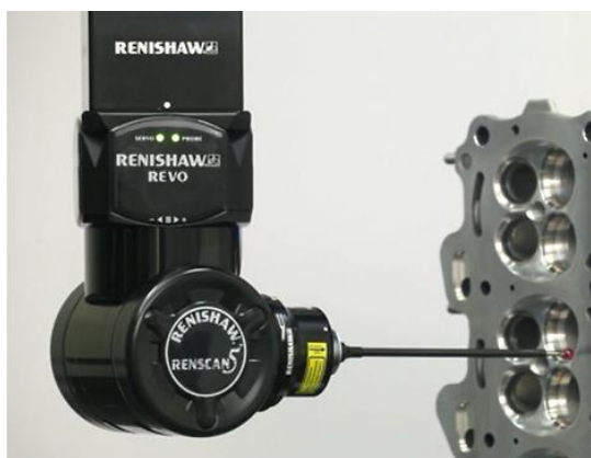
Obr. 28 Snímač REVO RSP2 umístěn v otočné hlavě Renscan5 [29]
