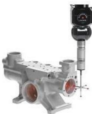
Obr. 19 Měření dotykovým snímacím systémem [6]
