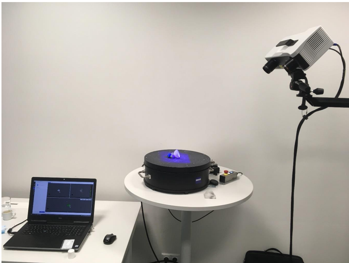
Obr. 73 Průběh skenování čočky
