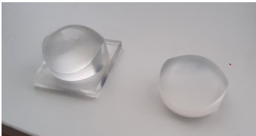
Obr. 58 Měřené artefakty, čočka s podstavou (vlevo) a čočka (vpravo)
