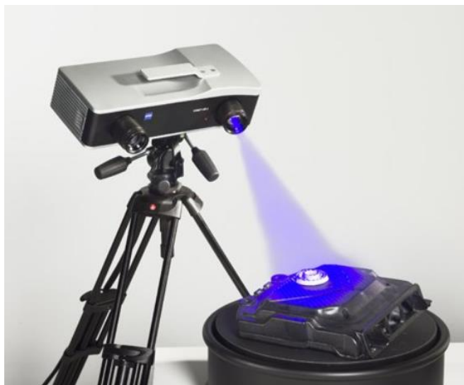
Obr. 31 Měření bezdotykovým optickým skenerem [25]
