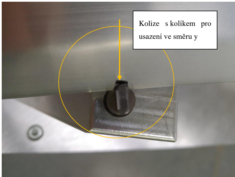
Figure 25 Detail kolize měřky s dílem
