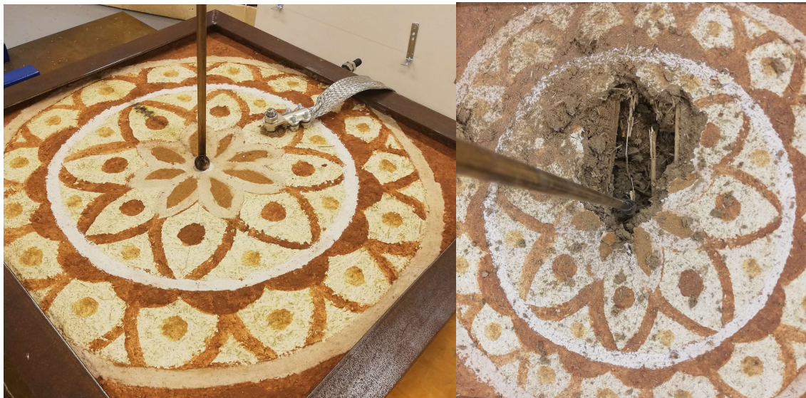
Obrázek 33 Účinek bleskového proudu na vzorku č. 1
