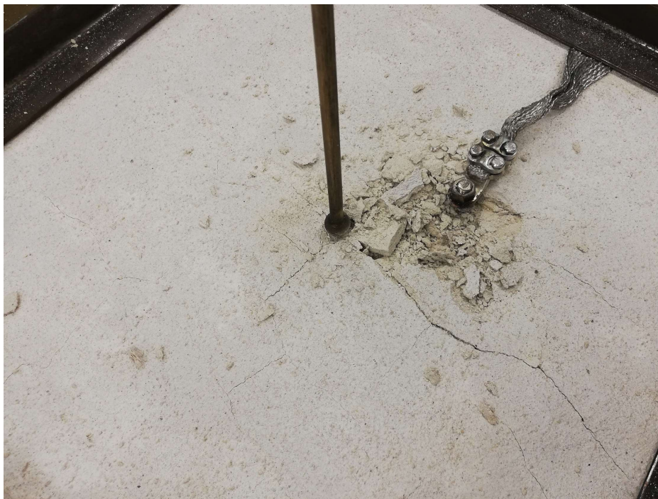
Obrázek 34 Účinek bleskového proudu na vzorku č. 3
