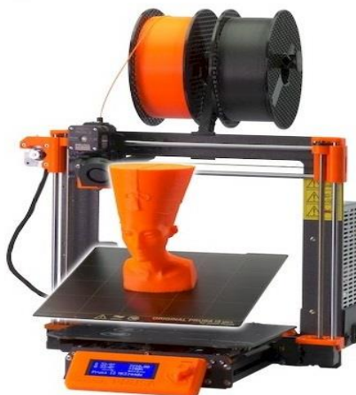
Obr. 25: 3D tiskárna MK3S [19]
