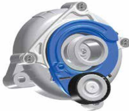
Obr. 17: Napínák řemene připevněný na alternátor [7]
