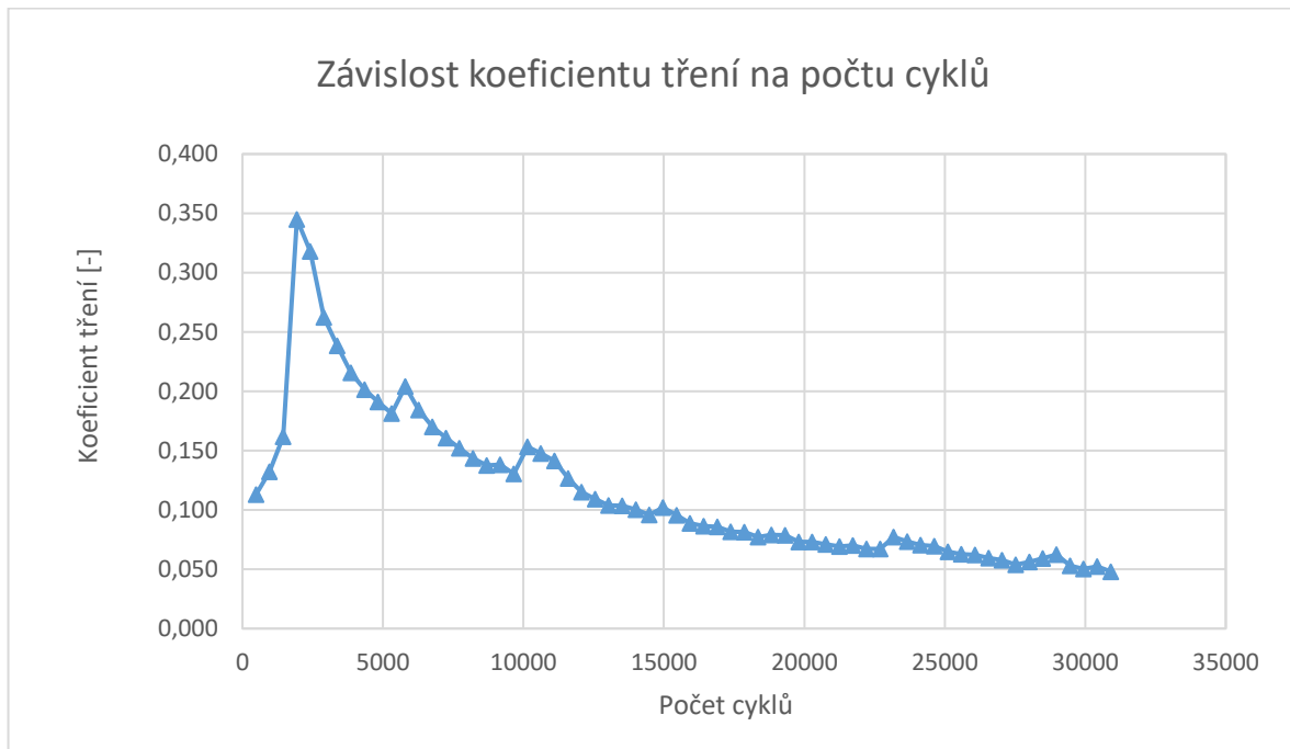
Obr. 51: Závislost koeficientu tření na počtu cyklů původní geometrie vytisknutého třecího elementu
