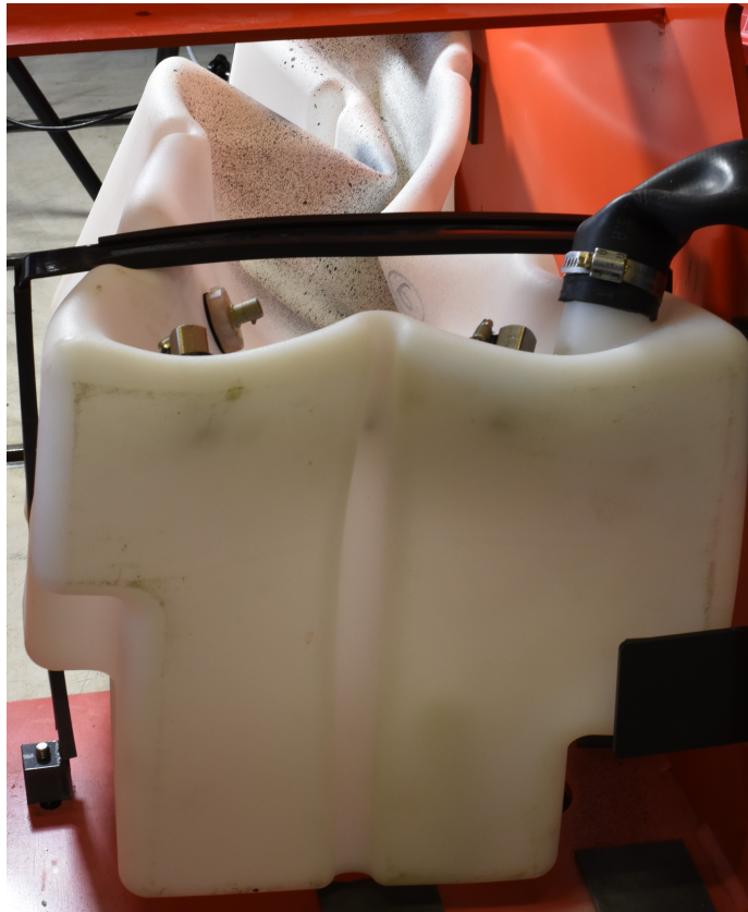
Obrázek 4.7: Zdeformovaná nádrž při maximálním zatížení
