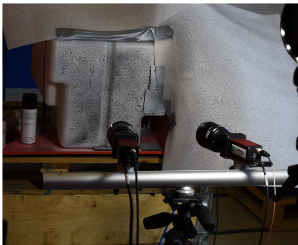
Obrázek 4.3: Uspořádání experimentu - první měření, před zatížením
