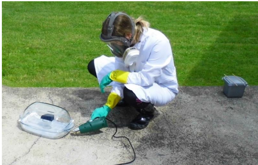
Obrázek 58: Zahřívání nádoby s chloroformem
