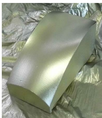
Obrázek 79: Vzorek C2 po nanesení první vrstvy barvy
