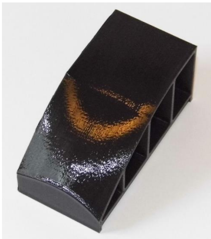
Obrázek 62: Vzorek C0 po naleptání
