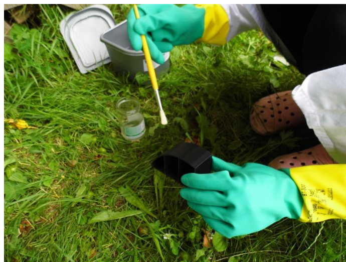
Obrázek 54: Nanášecí acetonu přímo na vzorek G1
