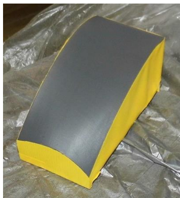
Obrázek 78: Zamaskovaný vzorek C2 po nanesení základu na plasty
