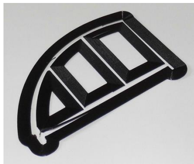
Obrázek 40: Odstraněný brim vzorku G2
