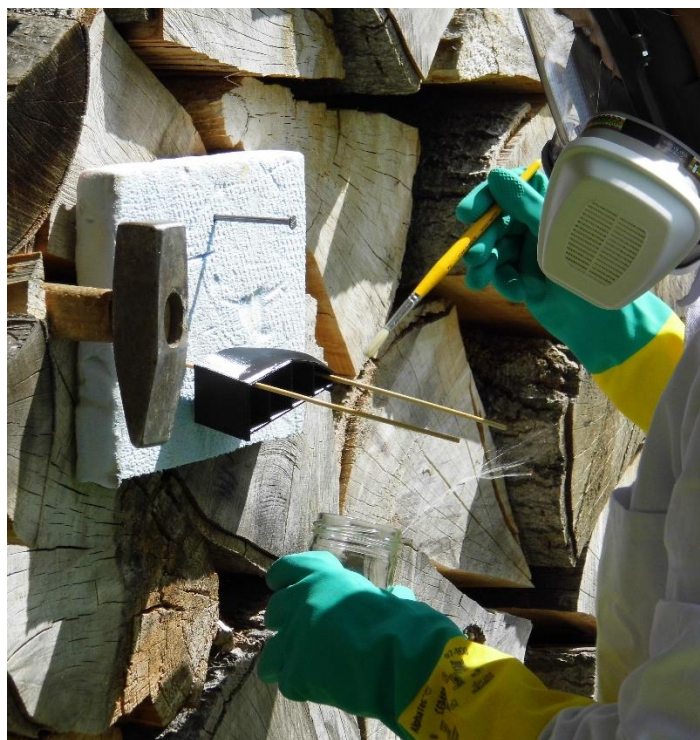
Obrázek 61: Nanášení chloroformu přímo na vzorek C0
