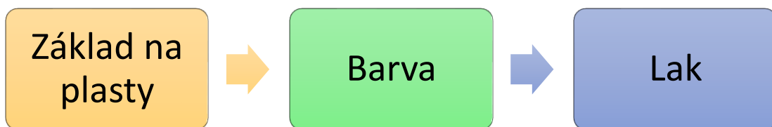
Obrázek 30: Zjednodušený postup úpravy
