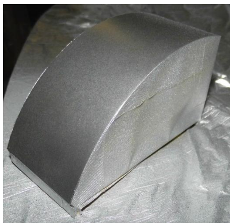
Obrázek 74: Vzorek G2 po nanesení první vrstvy barvy
