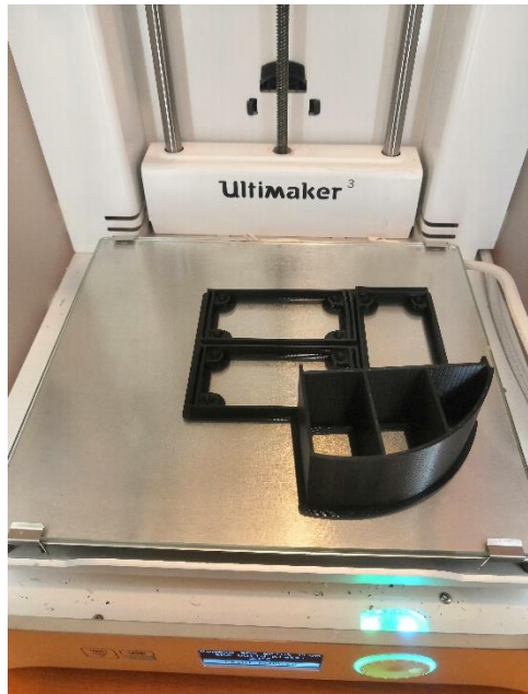
Obrázek 39: Tisk vzorku G2 a dílů pro upnutí
