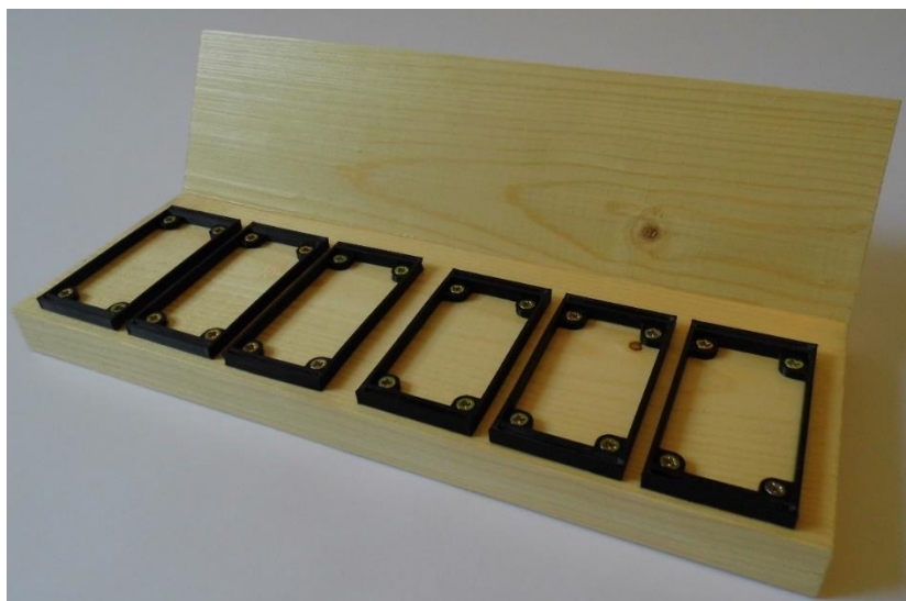
Obrázek 86: Sestava prken s díly pro uchycení vzorků
