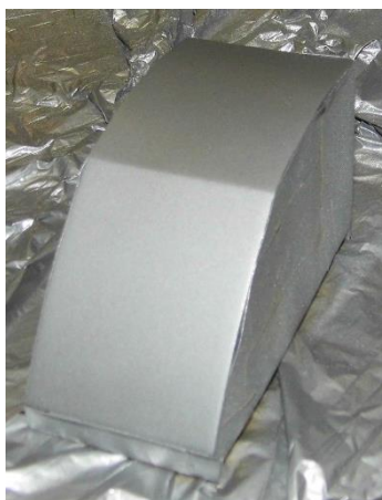
Obrázek 76: Vzorek G0 po nanesení první vrstvy laku
