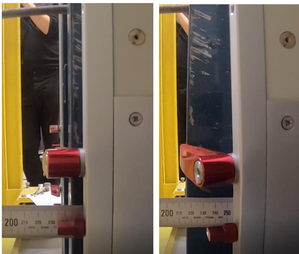
Obrázek 66 Boční retainer na začátku testu (vlevo) a v okamžiku ztráty kontaktu s maketou (vpravo)
