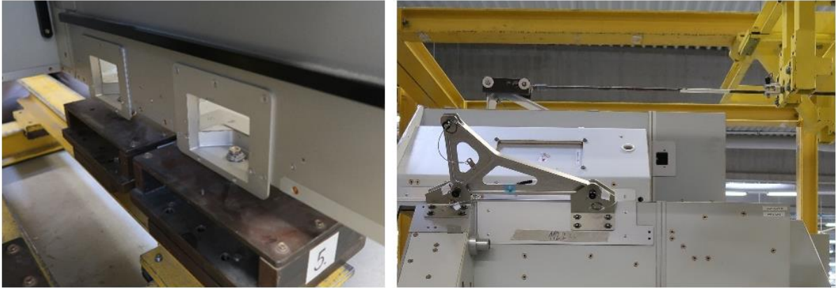
Obrázek 61 Detail uchycení kuchyňky k testovacímu rámu
