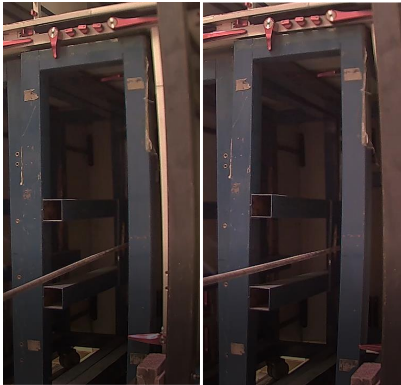
Obrázek 72 Experiment – boční panel bez zatížení (vlevo), při maximálním průhybu (vpravo)
