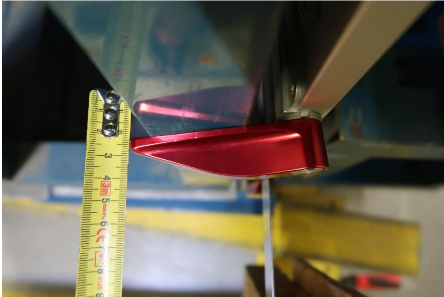
Obrázek 67 Trvalá deformace na bočním retaineru
