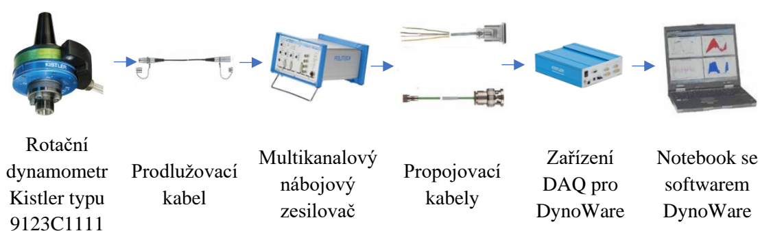
Obr. 65 Schéma zapojení měřicí aparatury řezných sil [44]
