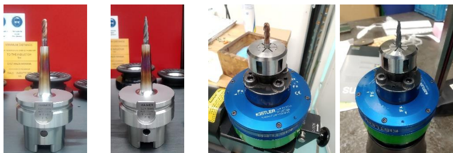
Obr. 53 Upnuté nástroje v mini upínači a kleštině rotačního dynamometru
