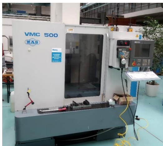
Obr. 49 Vertikální frézovací centrum VMC-500 a náklonný stůl
