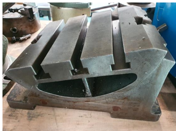
Obr. 49 Vertikální frézovací centrum VMC-500 a náklonný stůl
