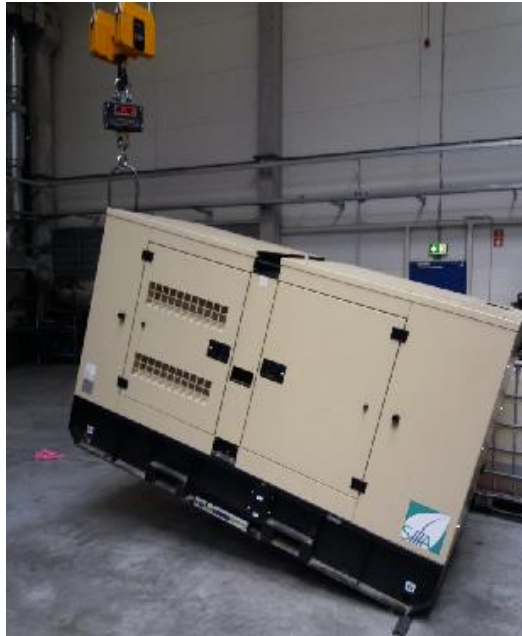
Obr. 19: Měření polohy těžiště
