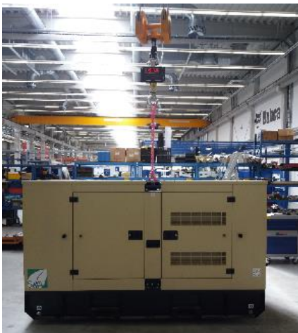
Obr. 18: Měření hmotnosti generátoru
