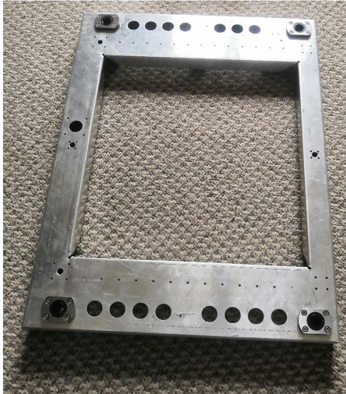
Obrázek 61: konstrukce Z s připevněnými lineárními ložisky
