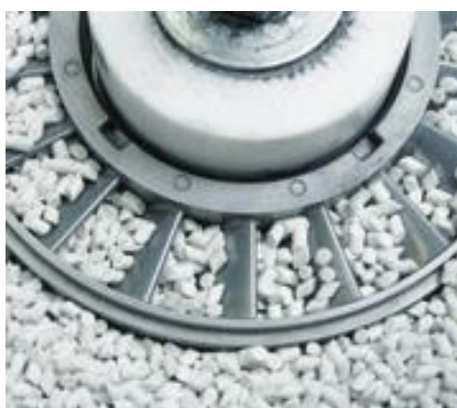
Obr. 15: Leštění lopatek turbíny procesem Keramo-Finish [21]
