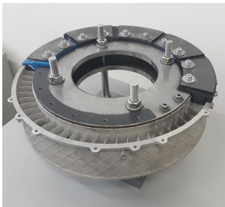
Obr. 57: Sestava optimalizovaného přípravku před druhým procesem omílání
