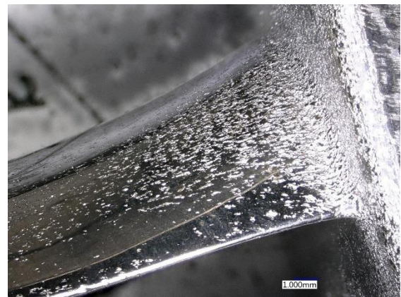
Obr. 59: Stav povrchu (hřbetu) lopatky rozvaděče po 2. leštícím procesu
