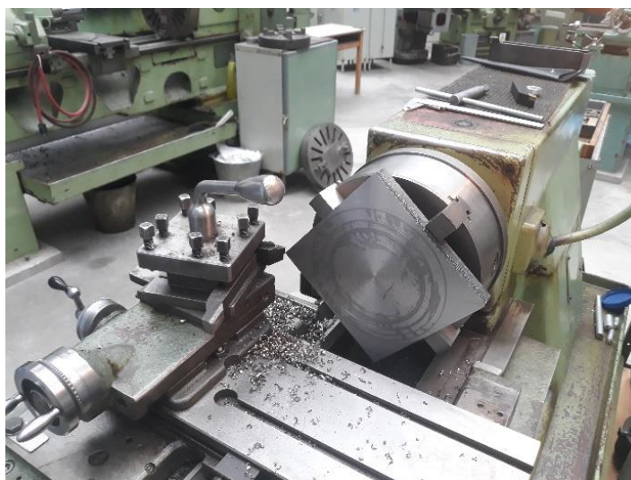
Obr. 41: Soustružení čelních ploch základny na konvenčním soustruhu SV 18 RA
