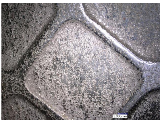
Obr. 54: Jakost povrchu hůře orientované vnější stěny rozvaděče
