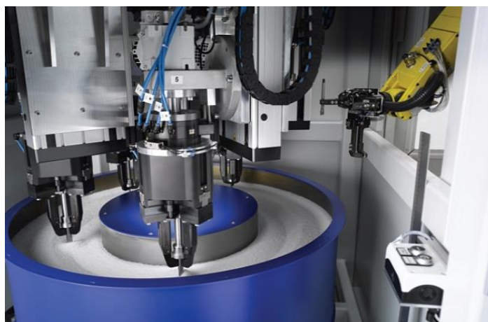
Obr. 18: Stroj řady Pulsfinish firmy OTEC Präzisionsfinish pro pulzní omílání [28]
