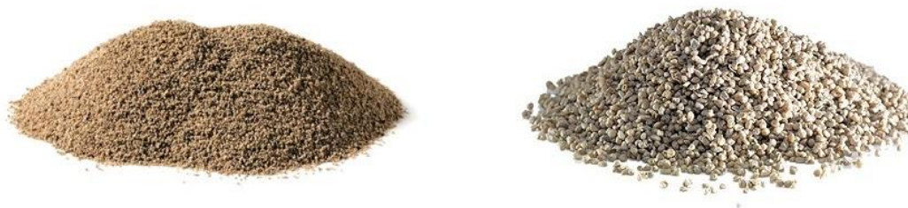
Obr. 11: Drcené ořechové skořápky (vlevo) a kukuřičný granulát (vpravo) [11]
