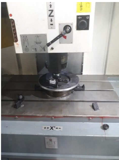
Obr. 42: Vrtání děr příruby ( \varnothing 13 mm) na CNC frézce VMC 500
