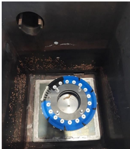
Obr. 49: Usazení přípravku do stroje LPG1 (pohled shora na magnetickou desku)
