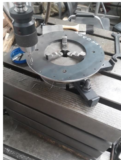
Obr. 43: Řezání závitů M6 do předvrtaných děr v přírubě na radiální vrtačce VR 4
