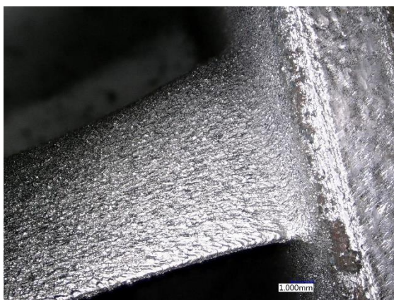
Obr. 51: Jakost povrchu (hřbetu) lopatky rozvaděče po 3D tisku (výchozí stav)
