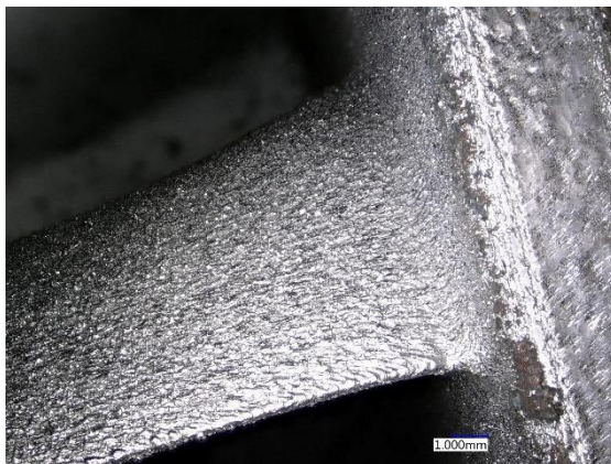
Obr. 58: Výchozí stav povrchu (hřbetu) lopatky rozvaděče
