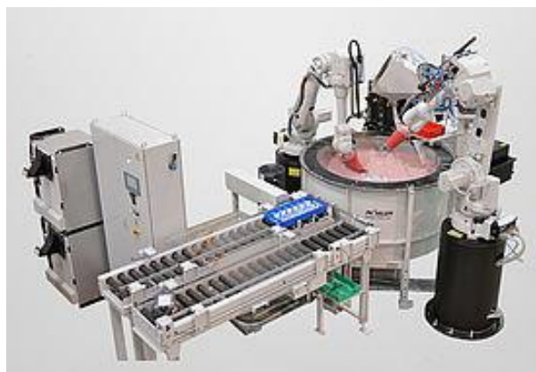
Obr. 16: Zařízení Surf-Finisher využívané pro dokončování lopatkových kol [22]
