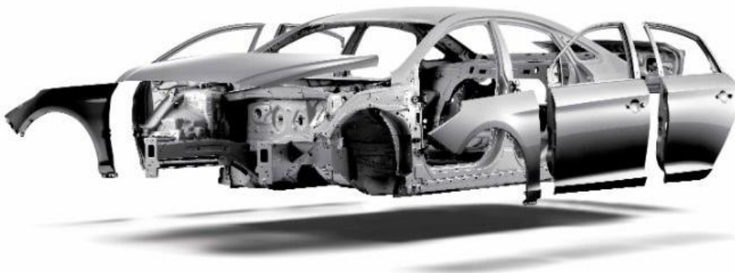
Obrázek 3.3: Skelet karoserie a panelové díly [22]
