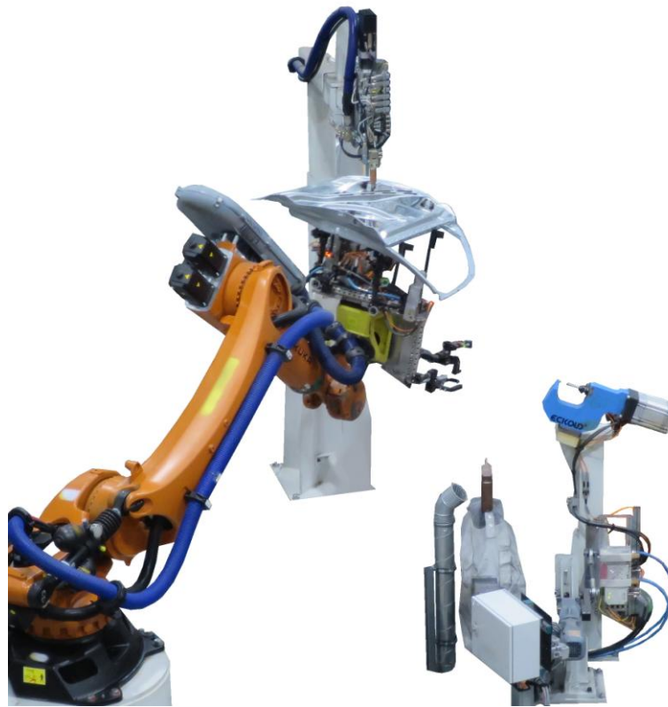
Obrázek 4.3: Automatické robotické pracoviště s nanášením lepidla, ražením prolisů a bodovým svařováním
