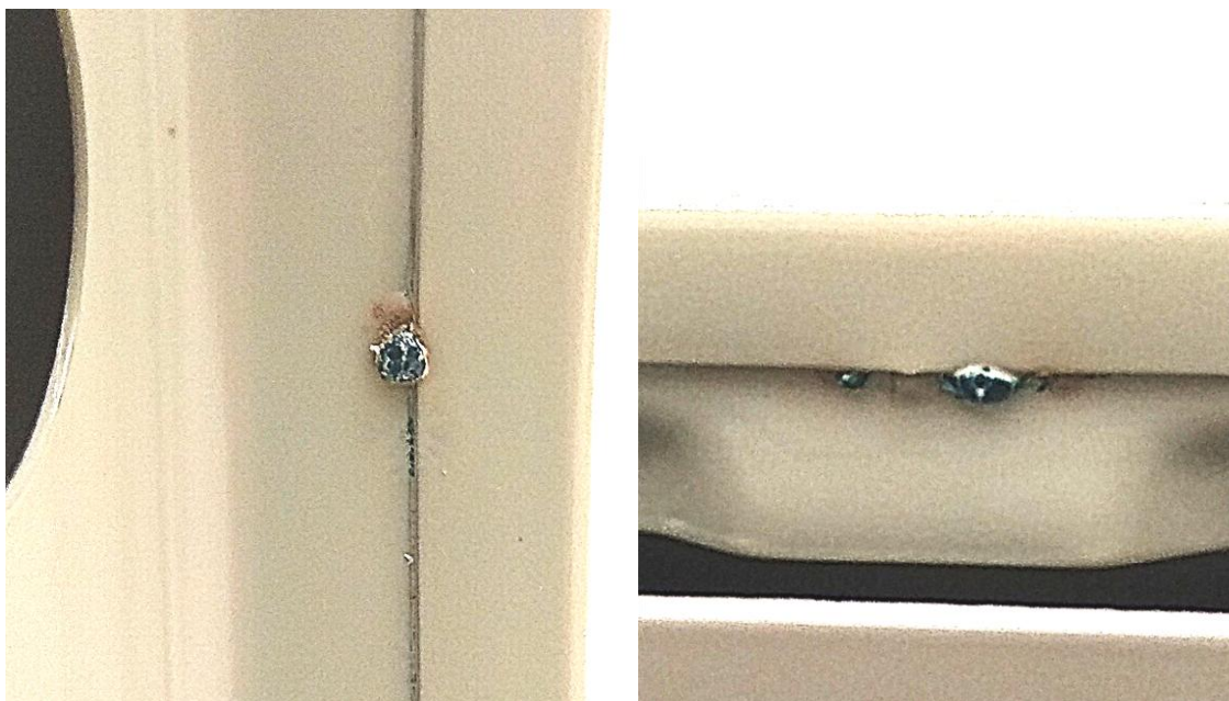
Obrázek 4.34: Vytlačené lepidlo v oblasti lemu s pojistným prolisem
