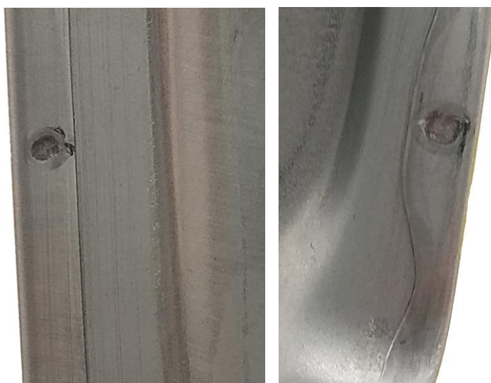
Obrázek 4.32: Vlevo je bod pojistného svaru na předních a vpravo na zadních dveřích
