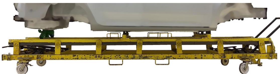
Obrázek 4.18: Transportní nosný rám určený pro manipulaci s karoserií, tzv. skid
