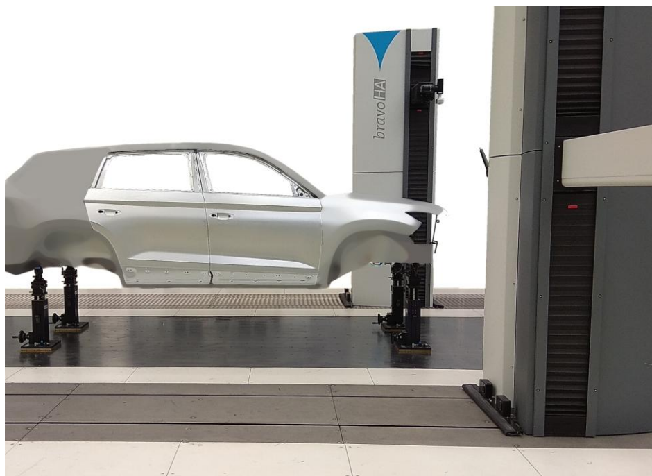
Obrázek 4.19: Dveře před KTL na ustavené okované karoserii na podpěrném a upínacím systému ZEISS CARFIT
