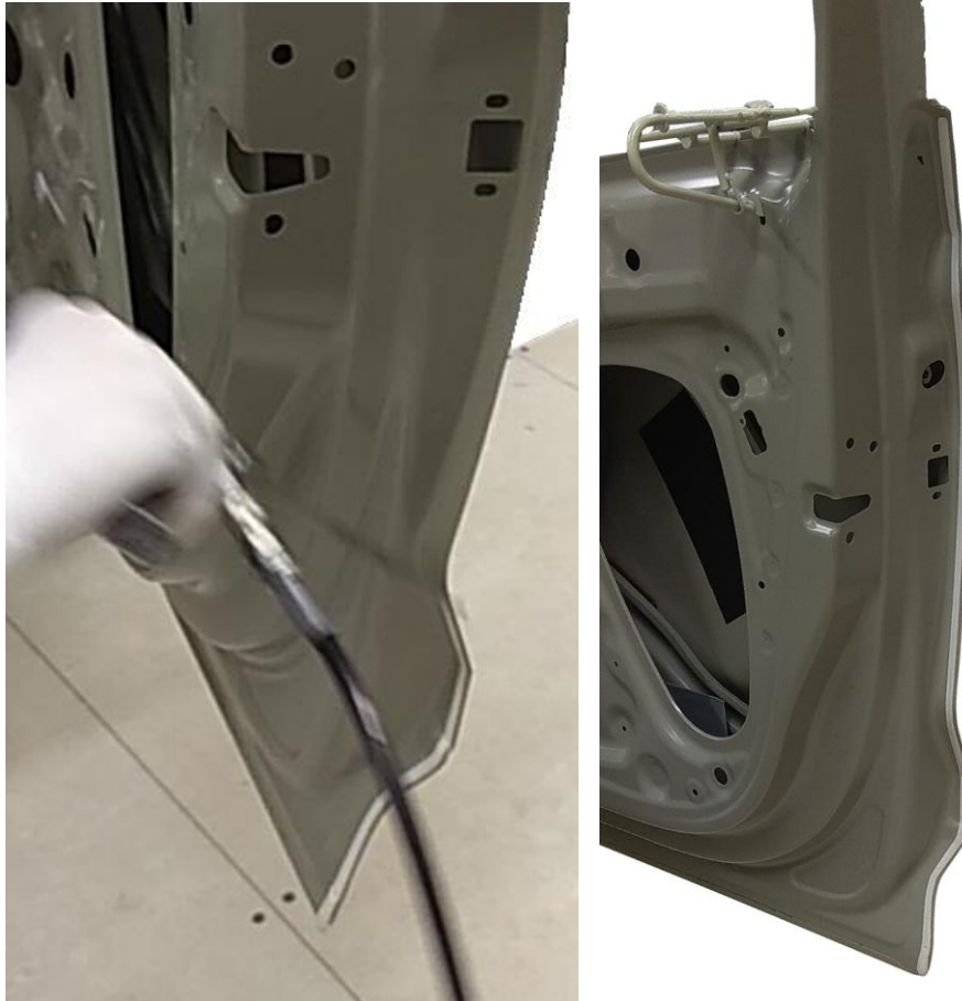
Obrázek 4.35: Vlevo aplikace těsnicího tmelu a vpravo správně aplikovaná housenka
