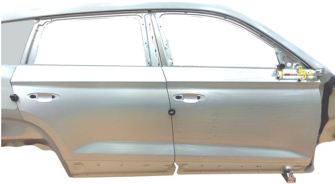
Obrázek 4.7: Použití ustavovacích přípravků při lícování předních bočních dveří
