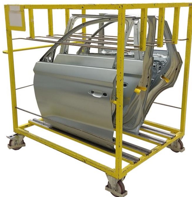
Obrázek 4.14: Celá sada dveří založená v technologickém vozíku
