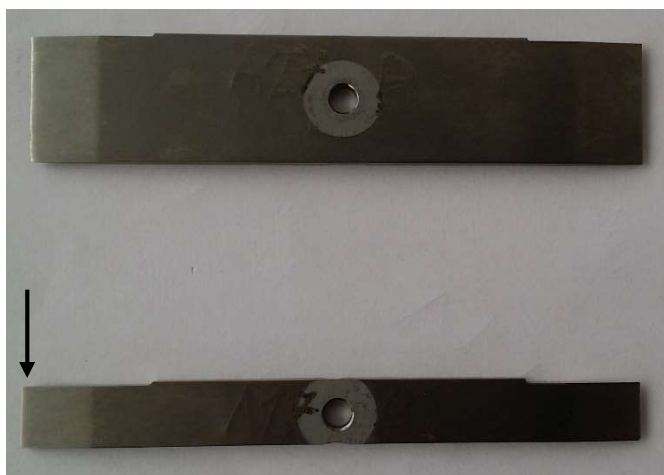
Obrázek 40 - Zbroušené vzorky pro vyhodnocení zaoblení ostří
