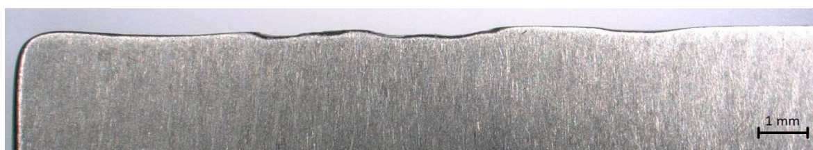
Obrázek 52 - Deformované ostří A (vzorek č. 34), pohled shora
