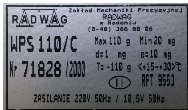
Obrázek 42 - Základní parametry váhy WPS 110/C
