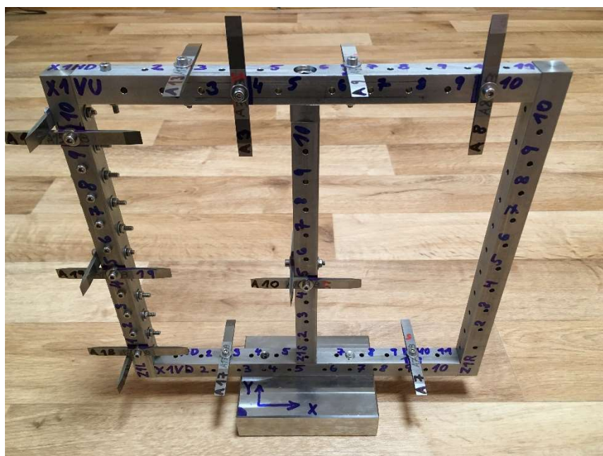
Obrázek 34 - Osazení zkušebního rámu, souřadnicový systém a systém pozic
