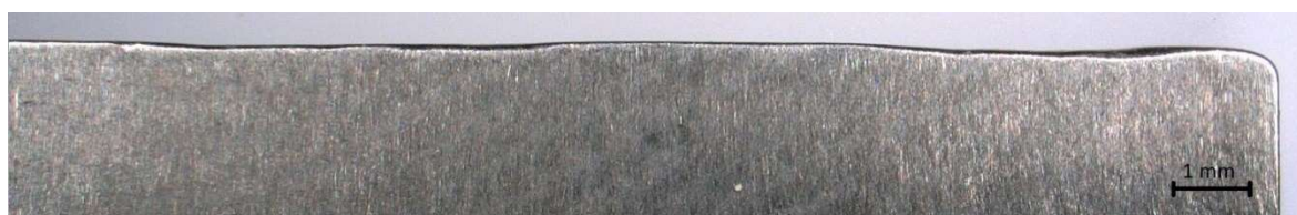
Obrázek 54 - Deformované ostří A (vzorek č. 43), pohled shora
