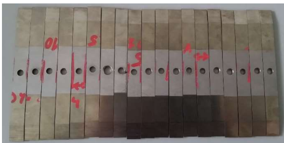
Obrázek 27 - Dokončená zkušební tělíska šířky 10 mm
