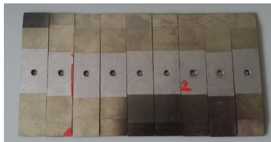
Obrázek 28 - Dokončená zkušební tělíska šířky 20 mm
