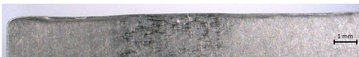
Obrázek 55 - Deformované ostří A (vzorek č. 43), pohled zdola
