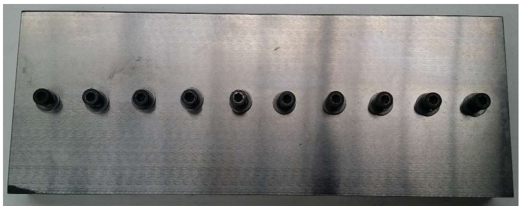
Obrázek 22 - Přípravek na upnutí plechu pro broušení rovinné plochy, pohled shora
