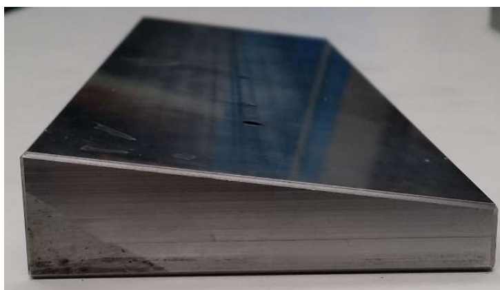
Obrázek 24 - Přípravek na upnutí plechu pro broušení ostří, pohled z boku
