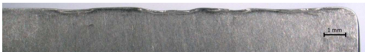
Obrázek 53 - Deformované ostří A (vzorek č. 34), pohled zdola
