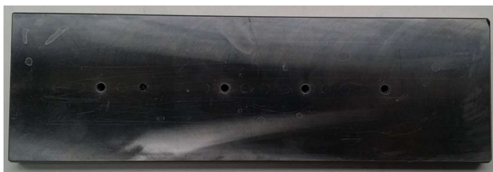
Obrázek 25 - Přípravek na upnutí plechu pro broušení ostří, pohled shora
