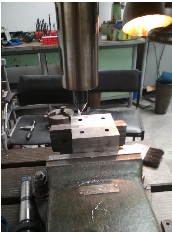
Obrázek 28 Polohování vřeteníku nad díru
