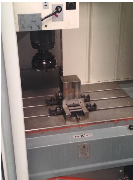
Obrázek 25 Frézování dosedací plochy železné kostky
