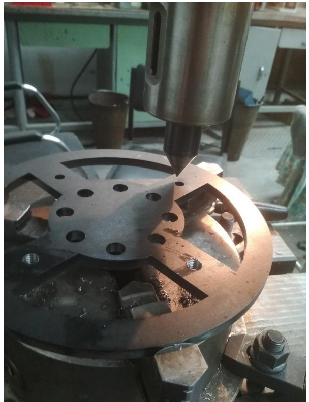
Obrázek 32 Polohování vřeteníku nad díru
