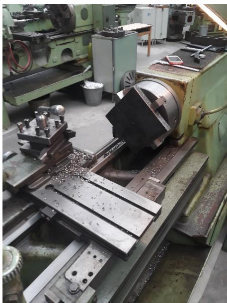
Obrázek 23 Soustružení čela desky
