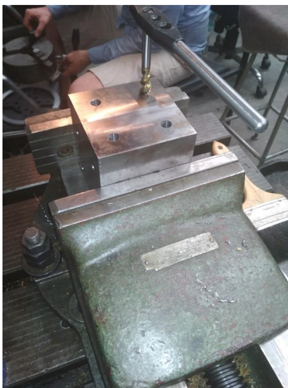
Obrázek 29 Řezání závitů železné kostky
