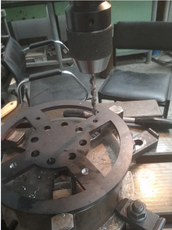
Obrázek 31 Vrtání děr pro závit
