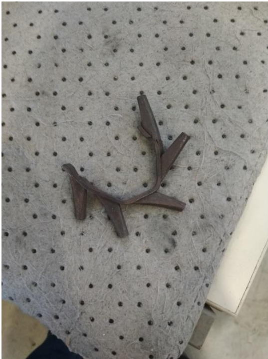
Obrázek 45 Deformace vnějšího segmentu
