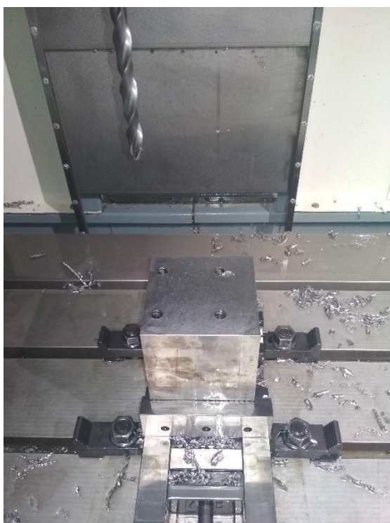
Obrázek 26 Vrtání průchozích děr železné kostky
