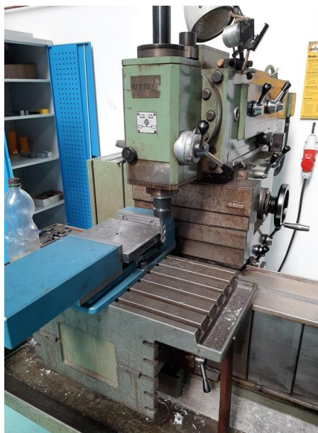
Obrázek 24 Frézování kontury základní desky
