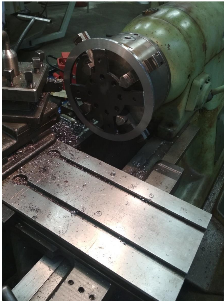
Obrázek 30 Soustružení drážky pro upínací část
