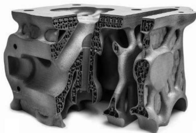
Obr. 34 - Hlava válců s odlehčenými strukturami [16]
