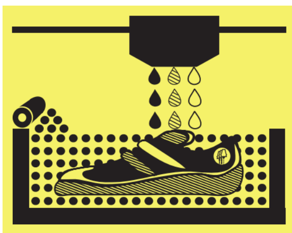
Obr. 5 - Schématické zobrazení metody Binder jetting [25]
