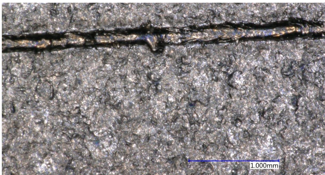
Obr. 33 - Rozstřík nataveného materiálu svaru P=275 W LS=275 mm/s
