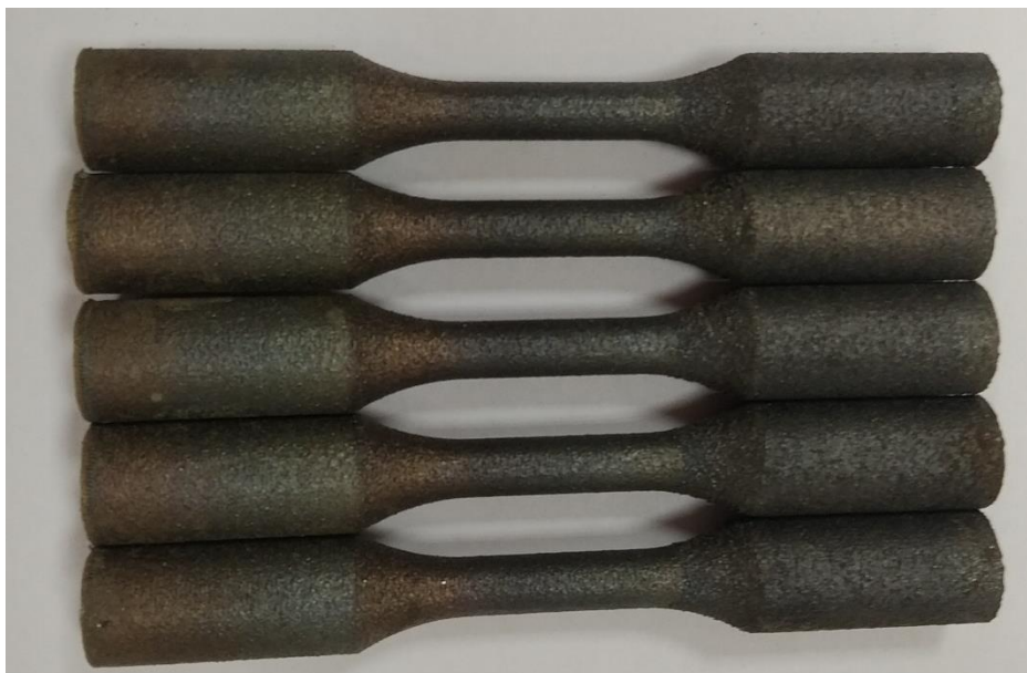
Obr. 58 - Vytištěná zkušební tělíška pro tahovou zkoušku
