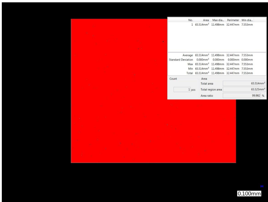
Obr. 56 - Určování relativní hustoty u vzorku č. 64
