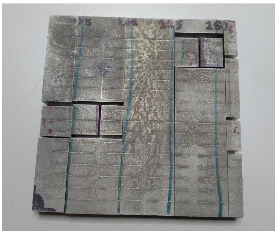
Obr. 35 - Systém rozřezání platformy s návarý
