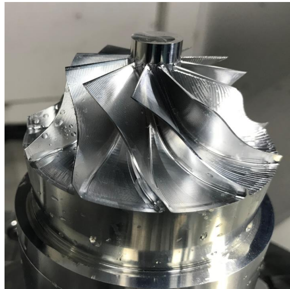
Obrázek 8-36 - Dokončené lopatkové kolo
