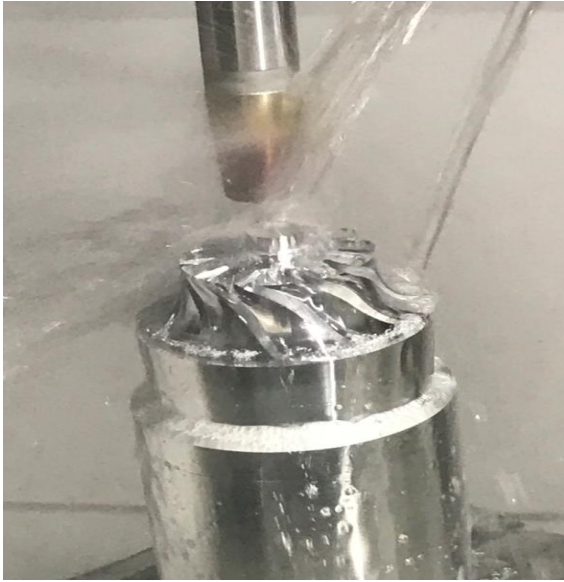
Obrázek 8-33 – Hrubování - otevírací řez
