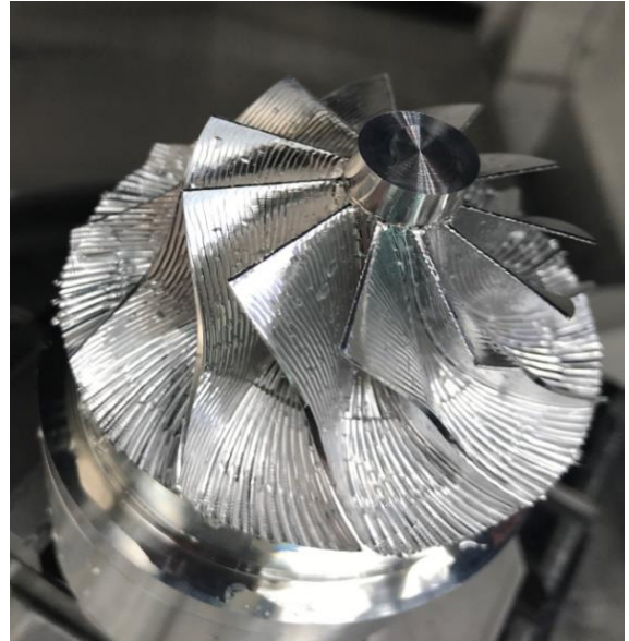
Obrázek 8-35 - Vyhrubované lopatkové kolo
