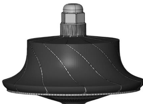
Obrázek 8-8 – Model polotovaru pro frézování
