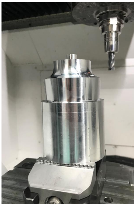
Obrázek 8-32 - Upnutí polotovaru pro následné frézování
