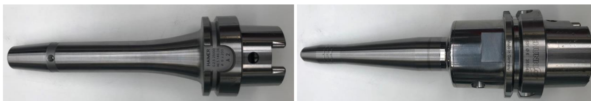
Obrázek 8-6 - Tepelný upínač Haimer (vlevo) a hydraulický upínač Schunk (vpravo)
