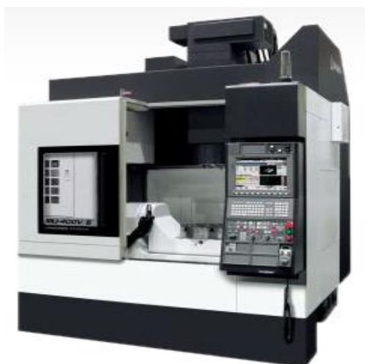
Obrázek 8-2 - Pětiosé svislé obráběcí centrum Okuma MU-400V II [55]
