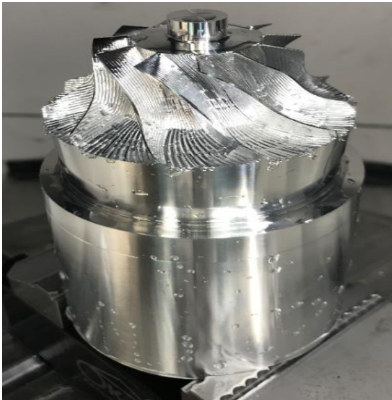
Obrázek 8-34 - Polohrubování první poloviny
